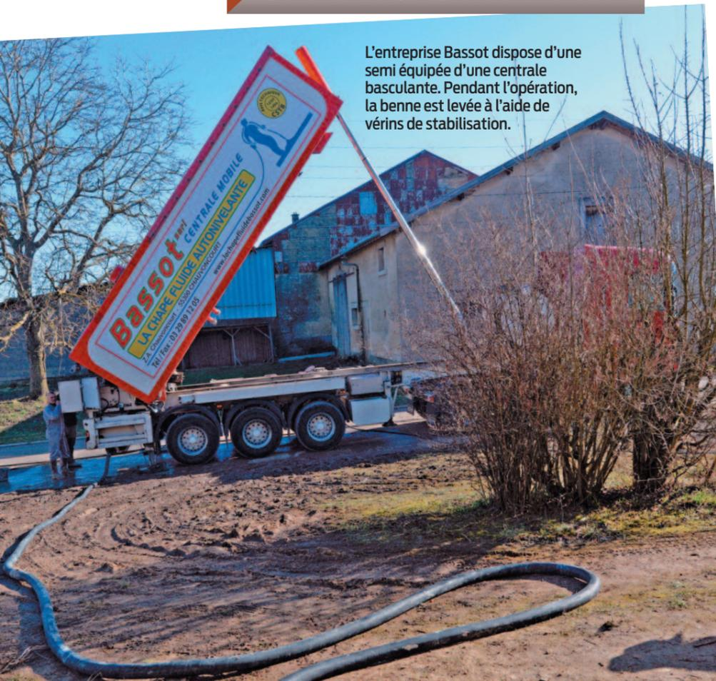
L'entreprise Bassot dispose d'une semi équipée d'une centrale basculante. Pendant l'opération, la benne est levée à l'aide de vérins de stabilisation.
